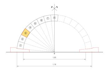
El arco terminado constará de 15 dovelas para conformar el montaje ilustrado en la imagen anterior. A cada grupo participante se le hará entrega de un máximo de 19 dovelas, por lo que deberán descartar las piezas menos adecuadas antes de proceder al montaje del arco, a fin de no comprometer su estabilidad. No se suministrará ni se podrá hacer uso de ninguna pieza a modo de cimbra ni apeo temporal.
